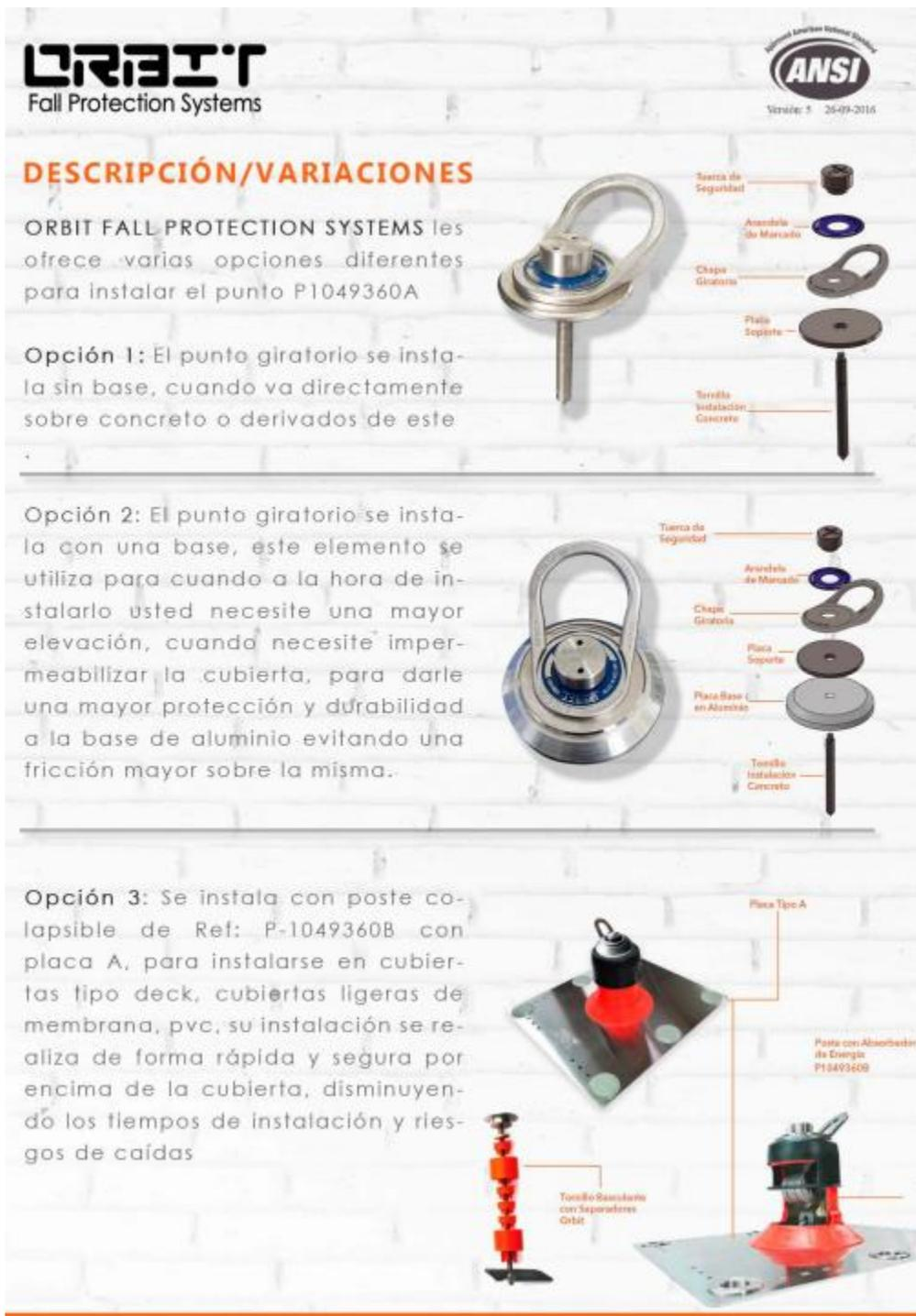
**Ilustración 44** Ficha técnica punto de anclaje ORBIT.
