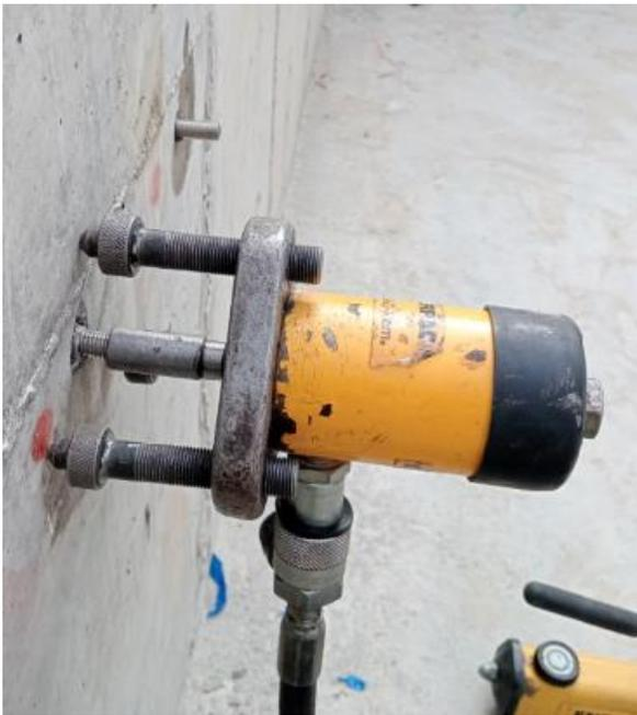
**Ilustración 12** Prueba de extracción en pernos.
