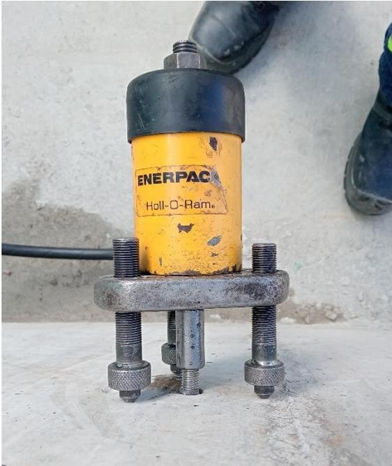
**Ilustración 11** Prueba de extracción en pernos.
