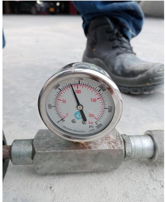
**Ilustración 13** Presión de **1304psi** aplicada al perno durante prueba de extracción.
