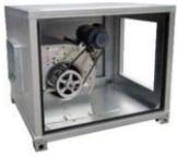
Unidades de ventilación diseñadas para la inyección y extracción de aire con opción en descarga horizontal o vertical **CDA**; su estructura está fabricada en lámina de acero galvanizada que la hacen un conjunto ideal para instalaciones en intemperie, marca S&P, modelo CDAH-12/12-0.33HP/4-700rpm-(220~3), con caudal 1.265 cfm y presión 0,512 Inwg.
