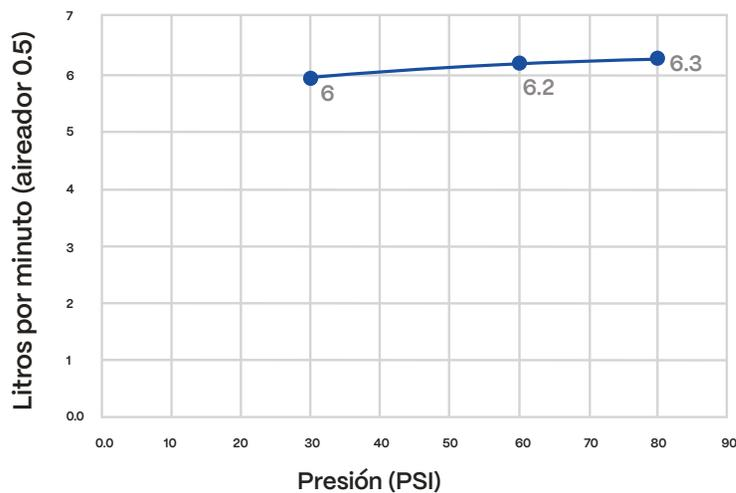
Nota: Los valores indicados varían según la presión de funcionamiento de la red hidráulica del lugar de instalación
