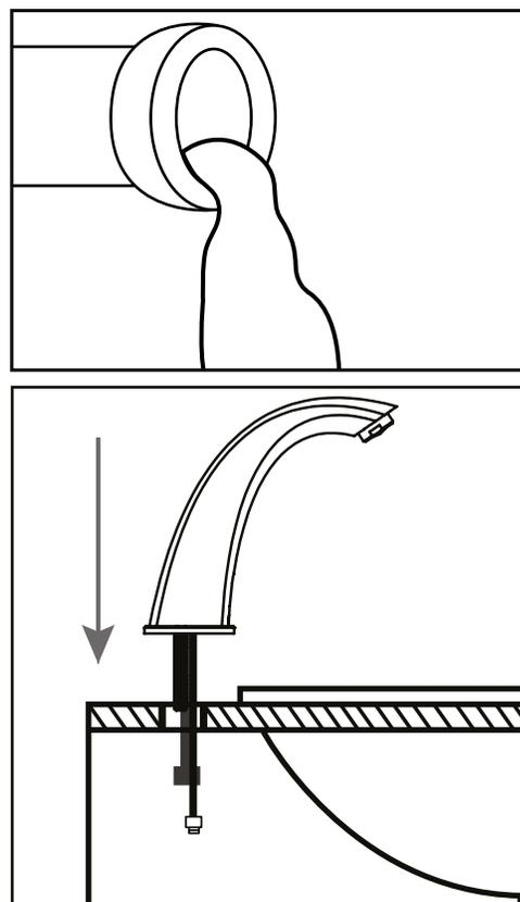
4. Proceda a apretar la tuerca de fijación, tenga en cuenta que el cuerpo del grifo puede girar a medida que aplica torque sobre la tuerca. Haga ajustes ocasionales para que el equipo quede alineado en la dirección deseada.
