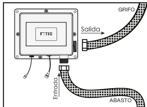
7. Fije el módulo eléctrico a la pared usando los chazos y los tornillos suministrados, verificando que la posición no perjudique el flujo del agua por las mangueras y que el cable del sensor quede con la holgura suficiente para ser conectado con facilidad.
