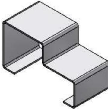
FABRICADO EN LAMINA GALVANIZADA CALIBRE 20 PARA MURO DE 10 cm, SOLDADURA MIC 0.35, CORTE EN LASER Y DOBLES EN PLAGADORA DE CONTROL NUEMERICO CON 8 PLATINAS PARA ANCLAJE DE TORNILLO A MURO, PINTURA LA HORNO ELECTROSTATICA.
