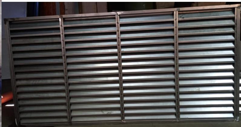
FABRICADA EN BASTIDOR EN TUBERIA CR-18 Y PERSIANAS EN LAMINA GALVANIZADA CALIBRE 20 MONOPANEL CON 3 REFUERZOS HORIZONTALES Y 2 VERTICALES, SOLDADURA MIC 0.35, CORTE EN LASER Y DOBLES EN PLAGADORA DE CONTROL NUEMERICO, PINTURA AL HORNO ELECTROSTATICA
