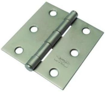
FABRICADA EN ACERO INOX Y GALVANIZADA CALIBRE 16, CON CAPACIDAD DE CARGA DE 27 KG CADA UNA, SOLDADURA MIC 0.35 APLICADA AL MARCO Y AL ALA COMO PUNTO REMACHE.
