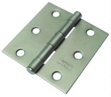
FABRICADA EN ACERO INOX Y GALVANIZADA CALIBRE 16, CON CAPACIDAD DE CARGA DE 27 KG CADA UNA, SOLDADURA MIC 0.35 APLICADA AL MARCO Y AL ALA COMO PUNTO REMACHE.
