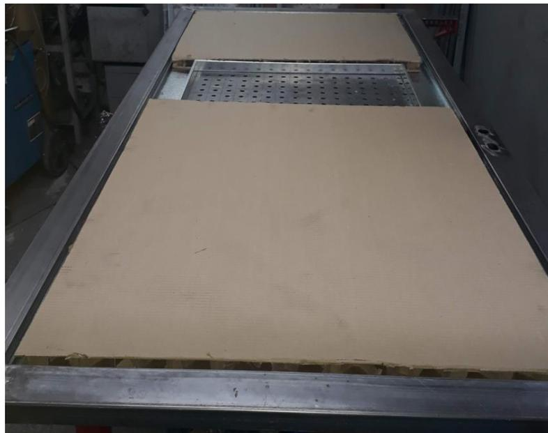
FABRICADA EN LAMINA GALVANIZADA CALIBRE 20 Y 18 DOBLE PANEL ENTAMBORADA, SOLDADURA MIC 0.35, CORTE EN LASER Y DOBLES EN PLAGADORA DE CONTROL NUEMERICO, CON 2 OMEGAS VERTICALES DE REFUEZO INTERNO Y 4 REFUERZOS PARA BISAGRA Y RELLENO CON PANELES DE HONEYCOMB FABRICADO EN CARTON, PINTURA AL HORNO ELECTROSTATICA
