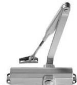
FABRICADO EN UNA ALEACION DE ZINC Y ALUMINIO EL CUERPO, MECANISMO HIDRRAULICO REGULABLE, CERTIFICACION UL, 2 MILLONES DE CICLOS PARA PUERTAS ENTRE 0-150 KG.
