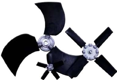
De gran diámetro a bajas revoluciones, aletas de perfil aerodinámico fabricadas en plástico reforzado con fibra de vidrio (PPG y PAG) de aletas múltiples y ángulo de ataque ajustable de acuerdo a selección por software. Características que logran disminuir apreciablemente los niveles de ruido y el consumo eléctrico.
